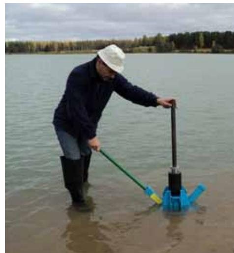
При достижении пробоотборником требуемой глубины, работу по забиванию штанг прекращают.
