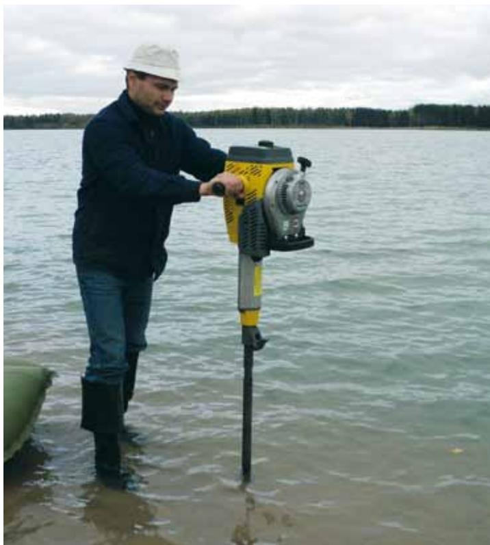
Благодаря своему малому весу, автономности и компактности, комплекс позволяет проводить геологоразведочные работы в местах, где их невозможно выполнить механизированным способом.
